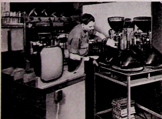
FOTO 3. — Tijdens de insmeltingsbewerking brengt deze machine het electronkanon automatisch op de juiste plaats in het halsvormig gedeelte van de glasballon van de Hytron 16RP4. Door middel van een zeer intense steekvlam wordt het kanon samengesmolten met de rechthoekige kolf.
